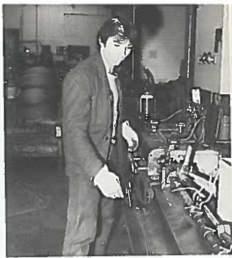
M. Nieto règle une machine à dresser les baguettes.
